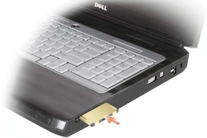
Il computer riconosce l'ExpressCard e carica automaticamente il driver di dispositivo appropriato. Se il programma di configurazione richiede di caricare i driver del produttore, usare il supporto fornito con l'ExpressCard.
