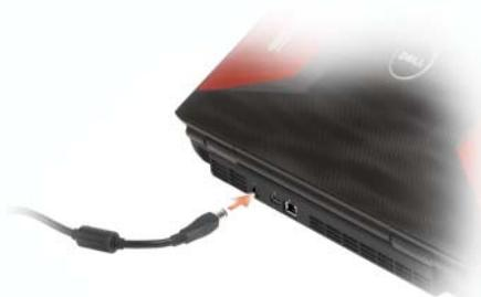
L'adattatore c.a. converte l'alimentazione c.a. in alimentazione c.c. richiesta dal computer. È possibile collegare l'adattatore c.a. quando il computer è acceso o spento.
